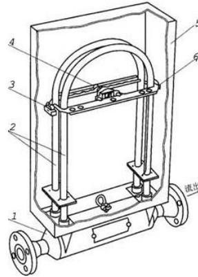
图2 U型管传感器结构图
