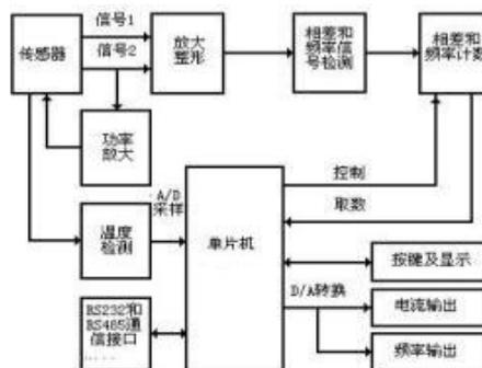
因此，直接或间接测量在旋转管道中流动流体产生的科里奥利力就可以测的得质量流量，这就是科里奥利质量流量计的基本原理。
